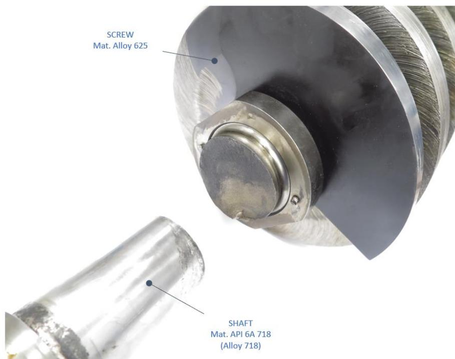
Fig. 2.6.5 - Exemplo de veio de liga de níquel fracturado por fenómenos de fadiga. Fonte: Laboratório do IIS.
