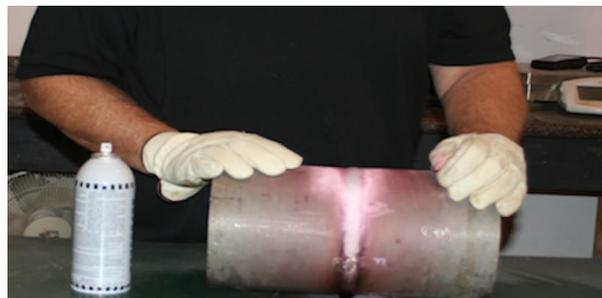
Fig. 1.3.28: Ensaio de Penetrante Líquido [1.3.37]
