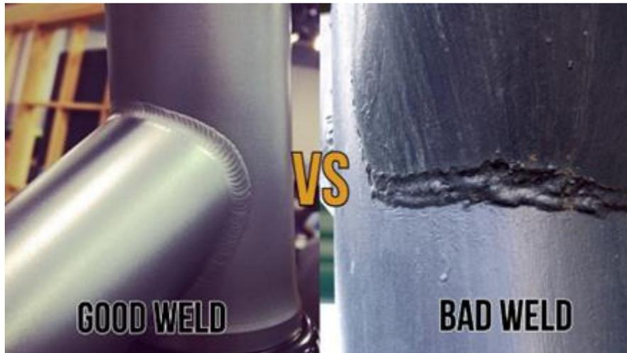
Fig. 3.2.32: Diferença entre uma boa e uma má soldadura, exemplo 1. Fonte: <https://waterwelders.com/good-weld-vs-bad-weld/>
