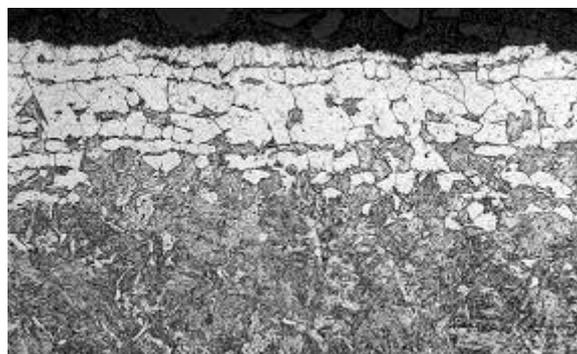
Figura 3.6.3. Superfície descarbonizada do aço C-Mn
