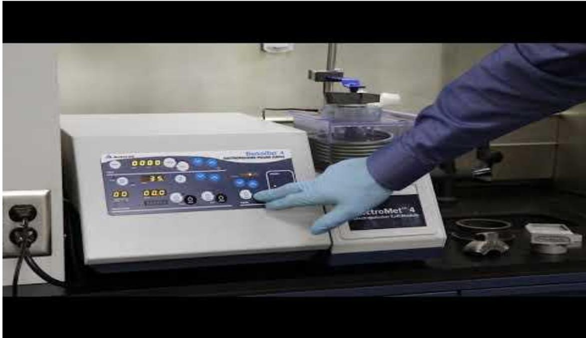
Figura 2.2.30. Demonstração de polimento e gravação ElectroMet 4 (fonte: BuehlerMaterials)
