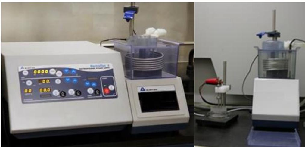
Figura 2.2.4. Equipamento de polimento eletrolítico com a célula electrolítica a descoberto (fonte: American Buehler Instrument Co., Ltd.)
