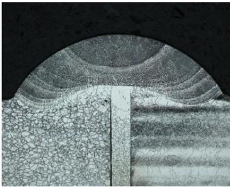
Secção polida mecanicamente e gravada electroliticamente através de soldadura micropulsada com gás inerte de tungsténio na liga Inconel 625. Gravado em ácido oxálico a 10%; 10 Volts durante 10 segundos. Campo brilhante, 2,5x.
