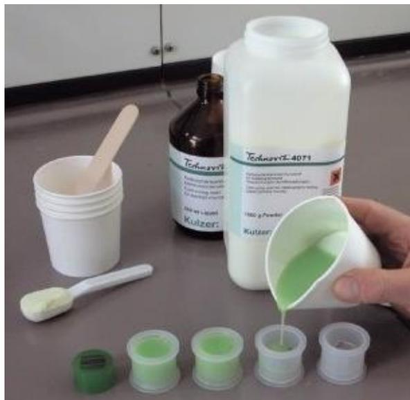
Figura 3.3.1.3. Exemplo de processo de embutimento a frio
