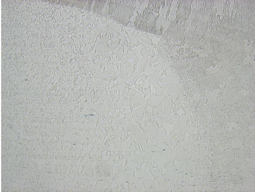
Fig. 3.5.10 - Zona termicamente afetada (ZTA) de um aço inoxidável austenítico do tipo AISI 316 (25 x). Grãos grosseiros na ZTA. Fonte: Laboratório IIS
