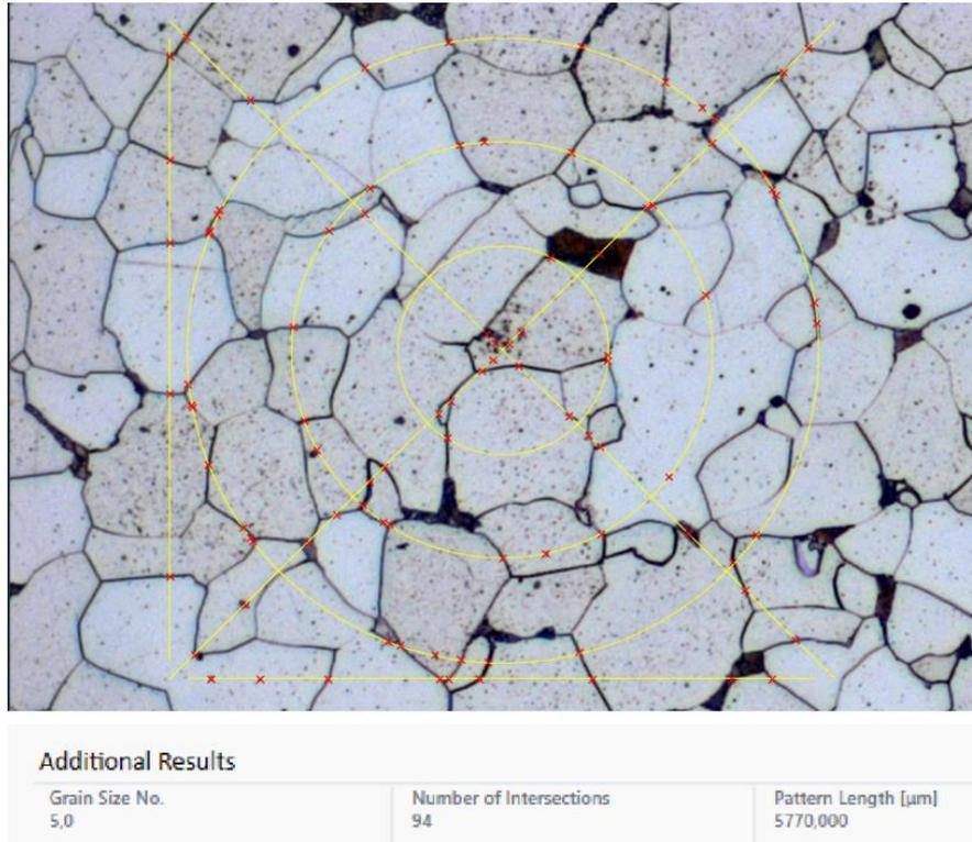
Fig. 2.3.13- exemplos de uma medição de intersecção efectuada num aço ao carbono. Fonte: Laboratório do IIS.
