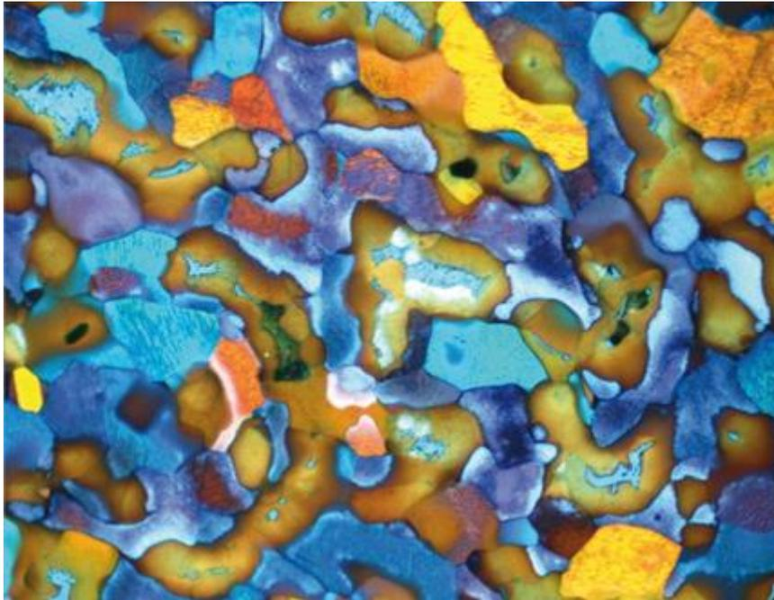
Figura 2.2.67. Diferenças de concentração num fio de bronze (K) (fonte: Leica Microsystems)
