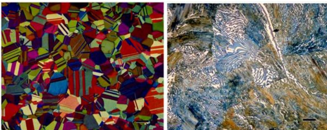
Figuras 2.2.52 e 2.2.53: Micrografia do latão do cartucho apresentado nas Figuras 2.2.11 e 2.2.12, corado com o reagente PbS de Beraha (esquerda) e cementite numa liga binária Fe-1% C laminada a quente, corada com o reagente molibdato de sódio de Beraha (direita). As barras de ampliação são de 200 e 20  $\mu\text{m}$ , respetivamente, (fonte: Vac Aero Coloured Metallography)
