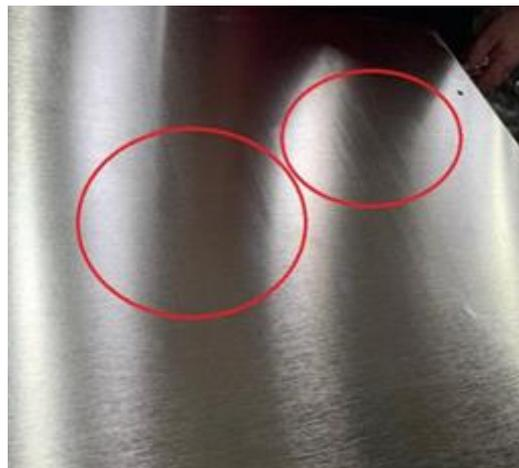
Figura 2.2.14. Polimento irregular numa chapa de aço inoxidável (fonte: AzOm)
