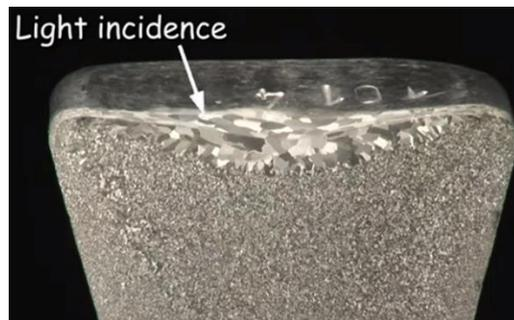
Fig. 2.1.41 Avaliação da fronteira de grão após polimento químico para aço inoxidável [2.1.17]
