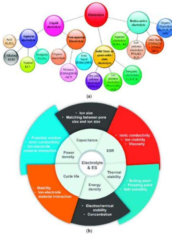
Figura 2.2.10. (a) Diferentes tipos de electrólitos adequados para aplicações específicas de SCs e (b) impacto do eletrólito no desempenho das SCs electroquímicas. (fonte: Tiwari, Santosh & Thakur, Anukul & De Adhikari, Amrita & Zhu, Yanqiu & Wang, Nannan. (2020). Pesquisa atual de nanocompósitos à base de grafeno e sua aplicação para supercapacitores. 10. 2046. 10.3390/nano10102046.)
