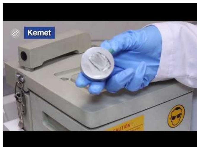
Fig. 2.1.3 Preparação electrolítica da amostra Polimento [2.1.3]
