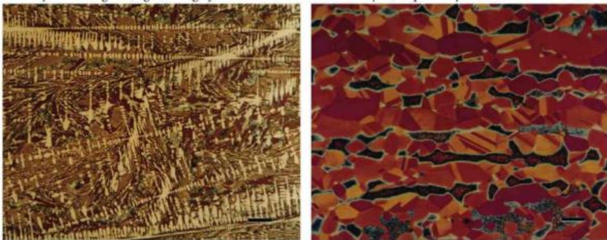
Fig. 2.1.31 e 2.1.32: Cementite na superfície fundida a frio de ferro cinzento gravada com o reagente de ácido selénico de Beraha para ferro fundido (esquerda) e fase alfa e fase beta geminadas de FCC (mosqueadas e delineadas) em Cu-40% Zn reveladas usando o reagente de ácido selénico de Beraha para ligas de cobre. As barras de ampliação têm 50 e 20  $\mu$ m de comprimento, respetivamente [2.1.14].
