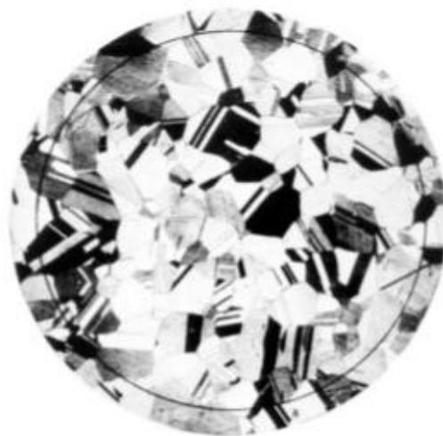
Fig. 2.3.9 - Exemplo de grãos gémeos (Etchs de contraste) da placa III - Tamanho de grão 4 a 75X - imagem retirada da ASTM E112. Fonte: [2.3.6] ASTM E112 - Standard Test methods for Determining Average Grain size
