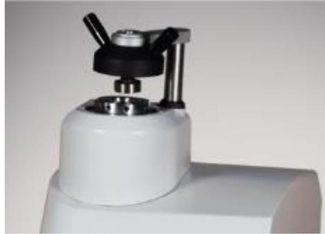
Figura 3.3.1.2. Máquina de embutir a quente
