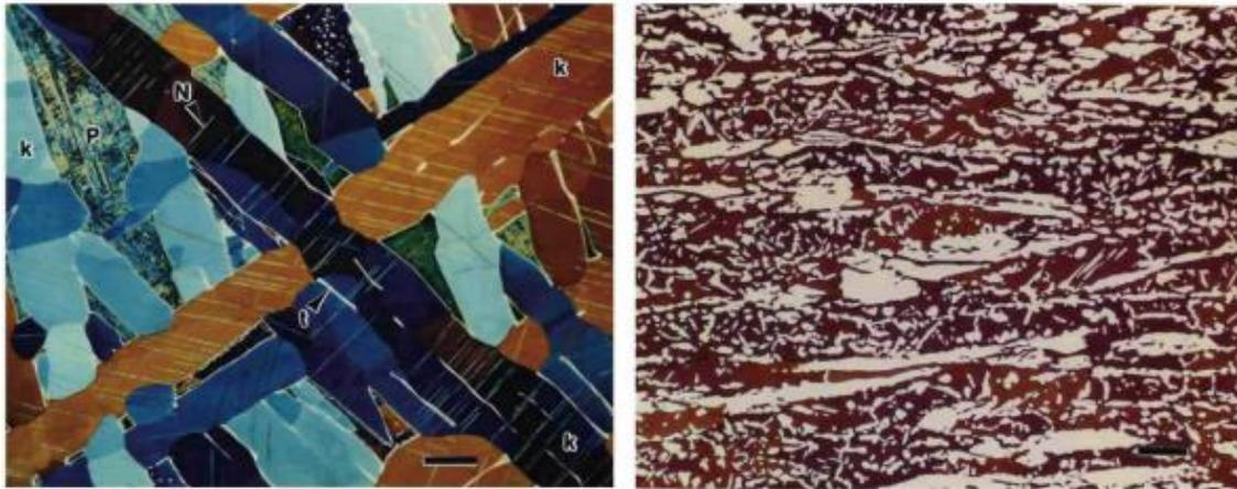
Fig. 2.1.24 e 2.1.25: Estrutura fina do grão de octaedrite do meteorito Gibeon (esquerda) revelada com o reagente Berahas (100 mL de água, 10g  $\text{Na}_2\text{S}_2\text{O}_3$  e 3g  $\text{K}_2\text{S}_2\text{O}_5$ ) e ferrite em placa de aço inoxidável duplex 7 Mo PLUS revelada com o reagente Berahas (85 mL de água, 15 mL HCl, 1 g  $\text{K}_2\text{S}_2\text{O}_5$ ). As barras de ampliação têm 500 e 50  $\mu\text{m}$  de comprimento, respetivamente [2.1.14].
