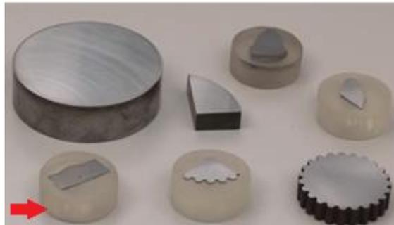
Figura 2.2.3. Amostras prontas para electropolimento (fonte: Kemet International Ltd)
