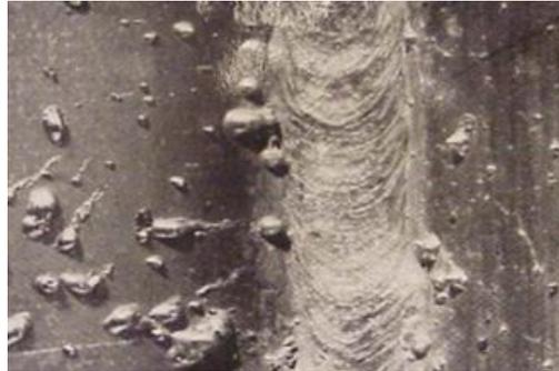
Fig. 3.2.10. Características visuais dos salpicos. Fonte: M.S. Rogers, Welding Inspection Defects/Repairs Course Reference WIS 5, 2003.
