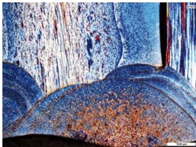
Figura 2.2.66. Gravura a cores de várias zonas de grão ou de mistura de cristais e camadas de sulfato de diferentes espessuras - Ligação por soldadura a laser de vários fios de aço austenítico (B) (fonte: Leica Microsystems)
