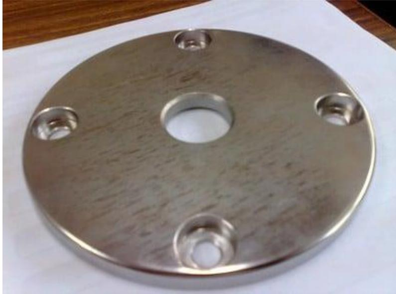
Figura 2.2.19. [Estrias na SS304 maquinada após electropolimento](#) (fonte: Global Spec)
