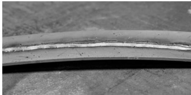
Fig. 1.3.20.2: Um exemplo de distorção [1.3.31]
