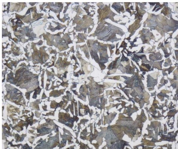
Fig. 3.5.5 - Pormenor de um aço de médio carbono do tipo C45 (C = 0,45 % em peso) - Ilhas de perlita e ferrite.
