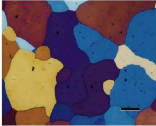
Fig. 2.1.21 A orientação do cristal anodizado de alumínio superpuro é realçada com o reagente Barker (30 Vdc, 2 minutos). A barra de ampliação tem 200  $\mu\text{m}$  de comprimento [2.1.14]
