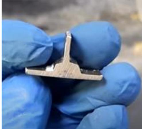
Figura 2.2.33. Preparação da amostra para gravação a cores (fonte: Vac Aero Coloured Metallography)
