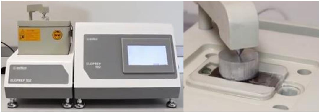
Figura 2.2.5. Equipamento de polimento eletrolítico com a célula electrolítica sobreposta (fonte: Kemet International Ltd)
