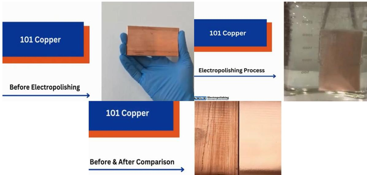
Fig. 2.1.37 Detecção de defeitos de superfície antes e depois do polimento eletrolítico do cobre 101 [2.1.16]
