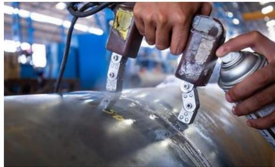
Fig. 1.3.27: Ensaio magnético [1.3.36]
