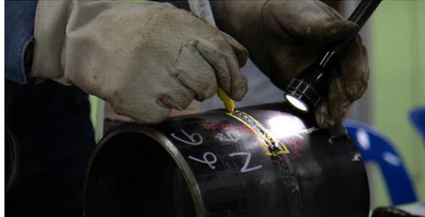
Fig. 1.3.29: Inspeção visual [1.3.38]
