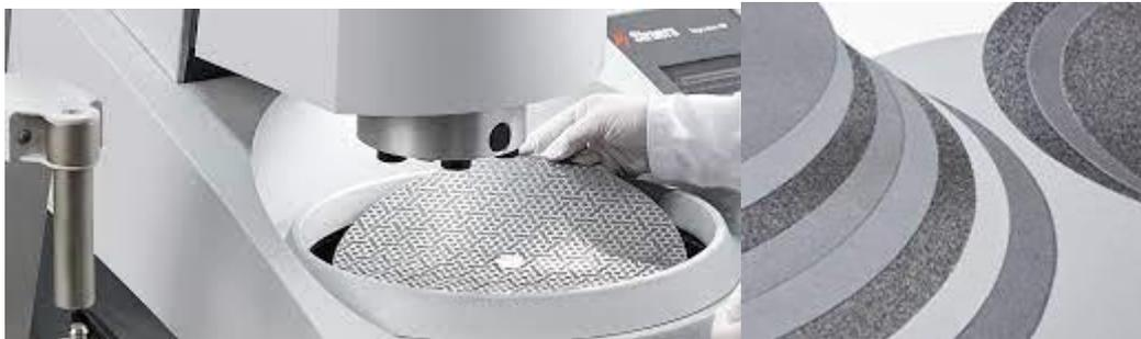
Figura 2.2.37. Máquinas ou equipamentos de retificação e polimento, papéis abrasivos (fonte: Kemet International Ltd)
