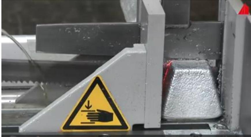
Figura 3.7.1. Corte mecânico sob arrefecimento a água
