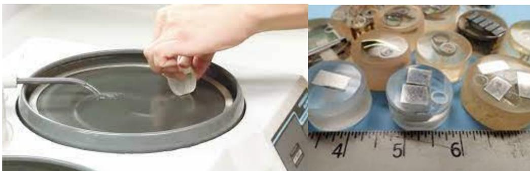
Figura 2.2.42. Preparação da amostra e exemplo de amostra (fonte: Kemet International Ltd)
