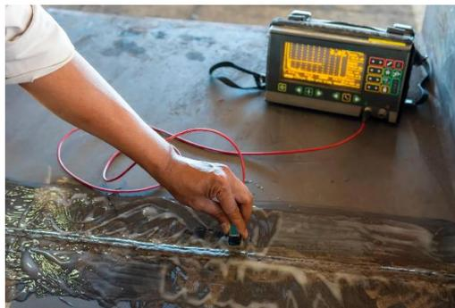
Fig. 1.3.25: Ensaio ultrassónico da soldadura [1.3.34]
