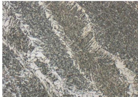
Micro secção polida e gravada através de aço carbono soldado MAG. A microestrutura consiste em ferrite acicular e primária. Gravada com Nital a 2%. Campo brilhante, 200x
