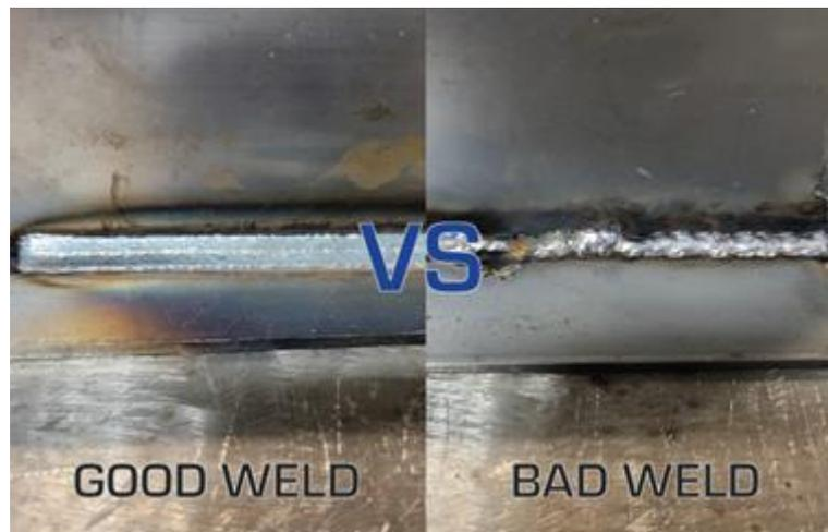
Fig. 3.2.33: Diferença entre soldadura boa e má, exemplo 2. Fonte: <https://blog.daihen-usa.com/why-welding-parameters-are-so-important-to-finished-quality>
